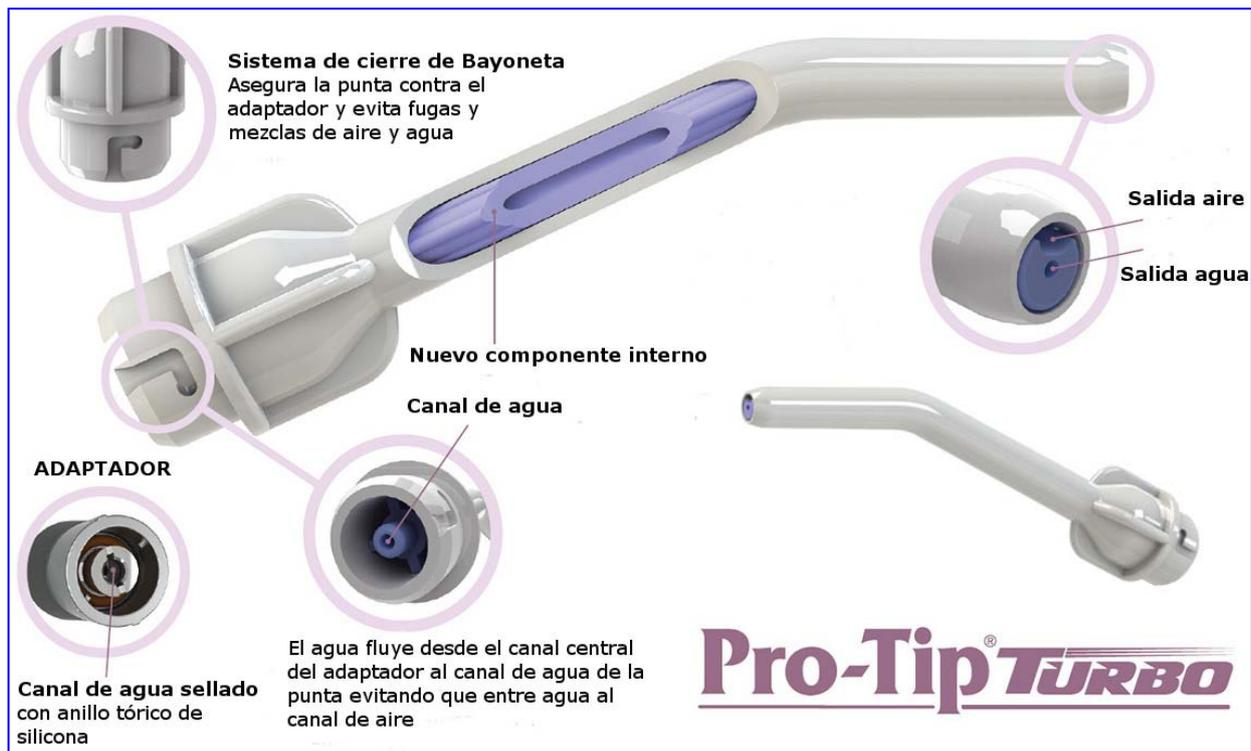
*El diseño de doble cámara garantiza la separación perfecta de agua y el aire*
