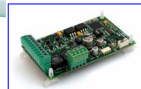
Fuente alimentación BMC40: -32V DC/CC +/-10%; 6A (10 seg.) - Dimensiones: 95x58mm.
