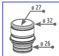
Ref.: 98-040125 Adaptador conexión d.i. Ø27, d.e. Ø32 – META Connect Macho/Macho, 1ud.
