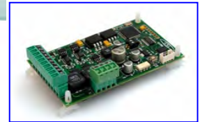
Fuente alimentación BMC40: -32V DC/CC +/-10%; 6A (10 seg.) - Dimensiones: 95x58mm.
