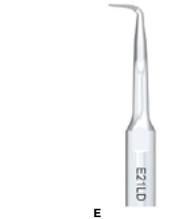
Diseñada para una eficiente modificación de ápice en retropreparación. El largo de la parte diamantada es 3mm. Diamantada: 30µm. Normalmente utilizada para la preparación de molares y premolares. Doblada hacia la izquierda. Recomendaciones: D600 Modo E, potencia 1-6 / S6: Modo E, potencia 1-9.
